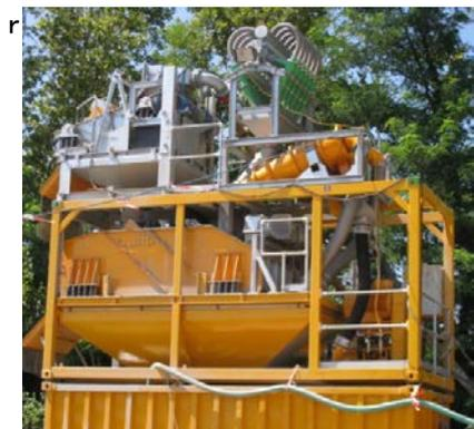
粗目スクリーンと微粒子用サイクロンアタッチメントを備えた、コンパクトなデサンダープラントは、特に掘進作業における展開に適しています。
