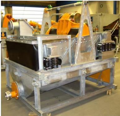
ES 250 は、主に注入、カッター土混入、混入土壁作業用に懸濁液を精製するために使用されます。
