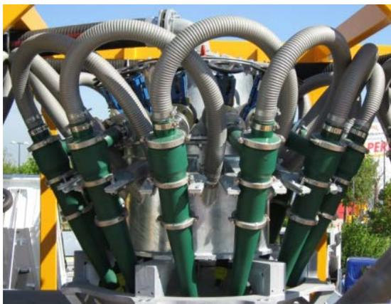
微粒子用サイクロンモジュールは、2～12基の一連の(4")サイクロンで構成されています。それらは全てBAUER製標準デサンダープラントに搭載が可能で、掘進や地下連続壁工事に主に使用されています。前処理済のスラリーや掘削泥は、250 m<sup>3</sup>/hまでの容量を有するバイパス作業で後処理されて中間シルトサイズの固形物になります。作業中に、分離された固形物は、標準のデサンダーユニットから排出された固形物上または分離用脱水スクリーン上に排出されます。
