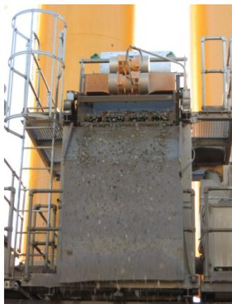
粗目スクリーンユニットGS 425、GS 425 V、GS 500、GS 500 VおよびGS 850は、大型のデサンダープラントと組み合わせて、主として予備分離用スクリーンとして掘進や地下連続壁工事に使用されます。投入されるスラリーの全容量が粗目スクリーンによって予備分離されます。V-型粗目スクリーンは、下向き25°から上向き6°の傾きまで段階的に調整されます。
