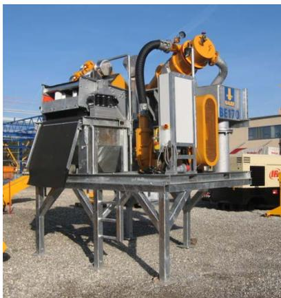
BAUER 製 BE 170-60 デサンダープラントは、建設業界で一般的に使用されるあらゆる種類のスラリーを大量に処理するために設計されています。斬新且つ革新的な支持フレームデザインによって、デサンダーを掘削孔や溝の中や上に直接設置することが可能です。支持フレームは、搬送時の保護用フレームとしての使用も可能です。BE 170-60 プラントは、BE 340 デサンダープラント内のモジュールとしても使用できます
